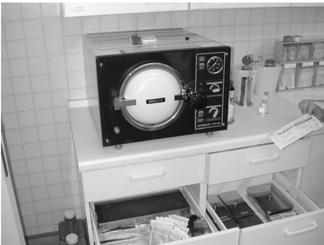
Abb. 5 ▲ Fehlerhafte, nicht an den Sterilisateur angepasste Sterilgutverpackung: abgebildeter Dampfsterilisateur nur für dampfdurchlässige Lochkassetten, nicht für dampfundurchlässige Glas- und Metallkassetten ohne Löcher (diese sind für Heißluftsterilisatoren geeignet) verwendbar
